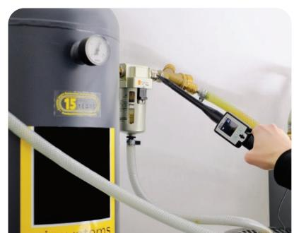
Mit dem Fokussierrohr und der Fokusierspitze die genaue Position finden.
