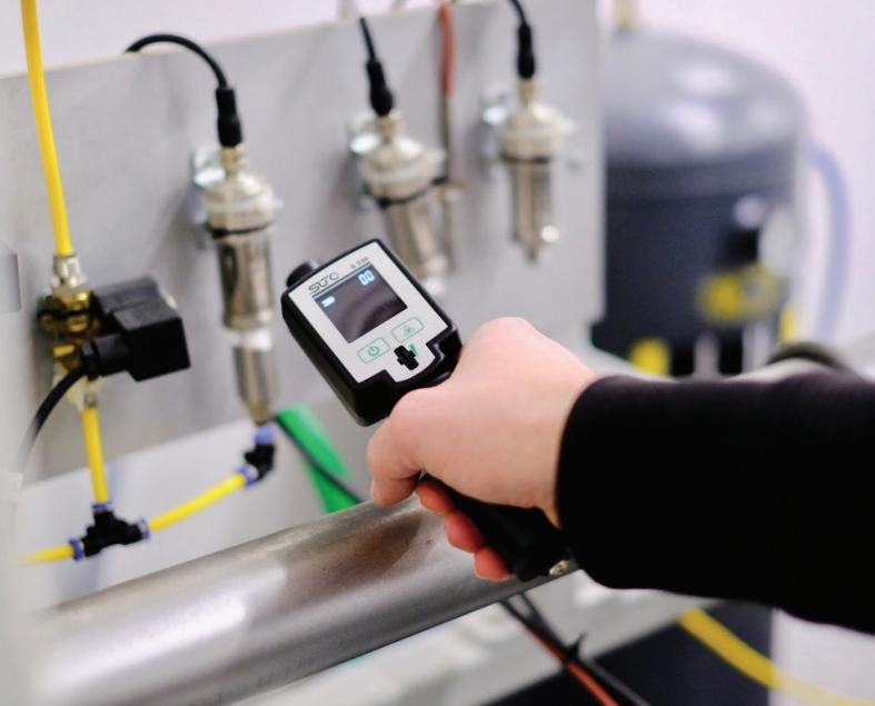
Wenn Gase aus Rohren und Behältern austreten, wird ein Ultraschallton erzeugt, der vom S530 noch aus mehreren Metern Entfernung erkannt werden kann.
